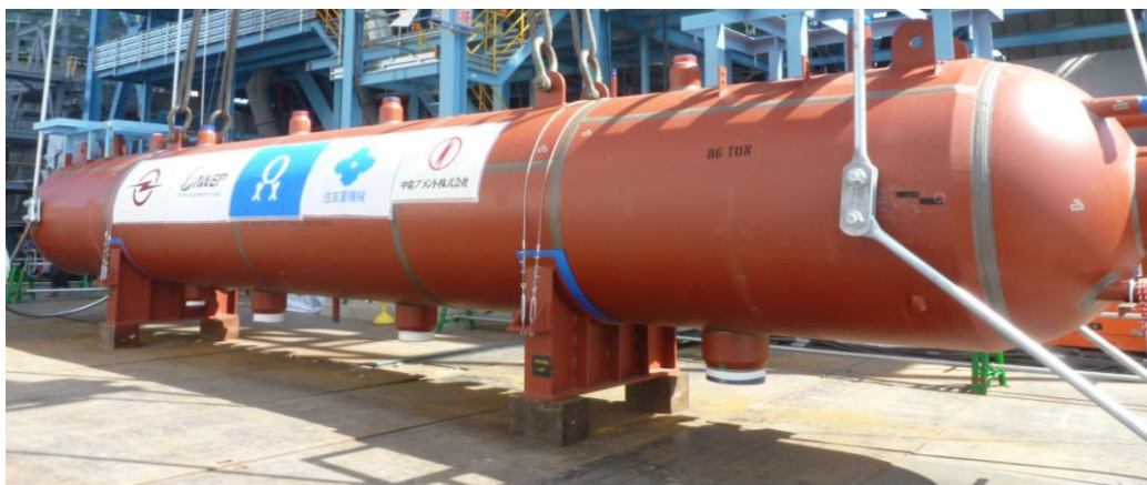
▲蒸気ドラム本体 全長約14.5m、重量はおよそ83.7t
